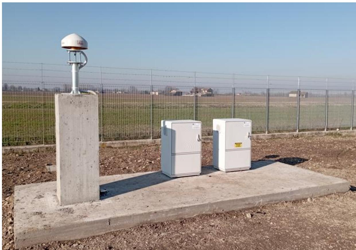
*Struttura della monumentazione dell'antenna GPS.*
