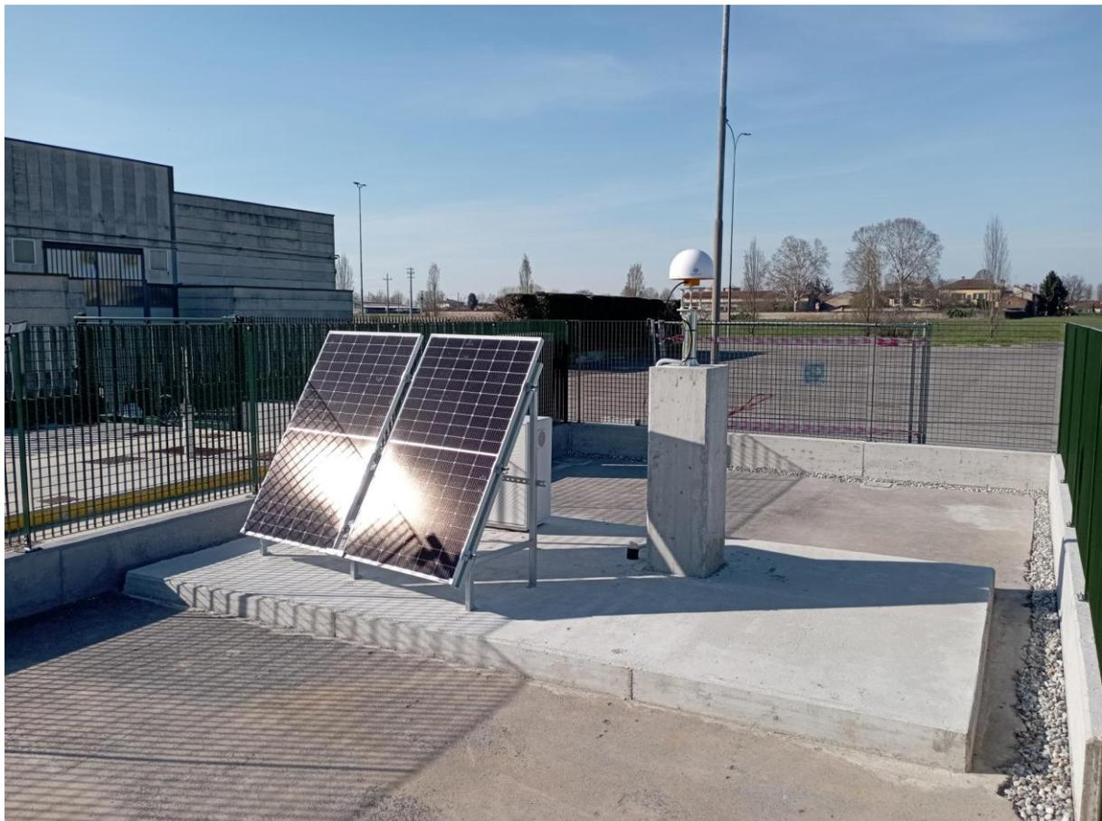
*Struttura della monumentazione dell'antenna GPS.*
