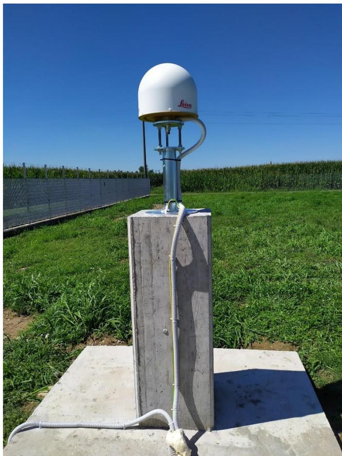
*Struttura della monumentazione dell'antenna GPS.*
