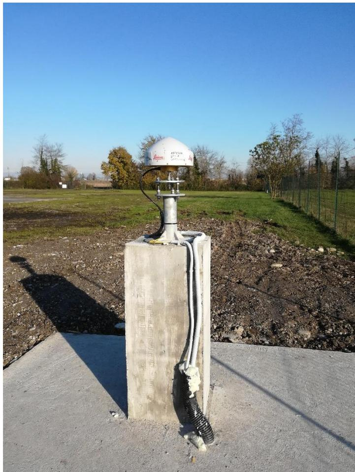
*Struttura della monumentazione dell'antenna GPS.*
